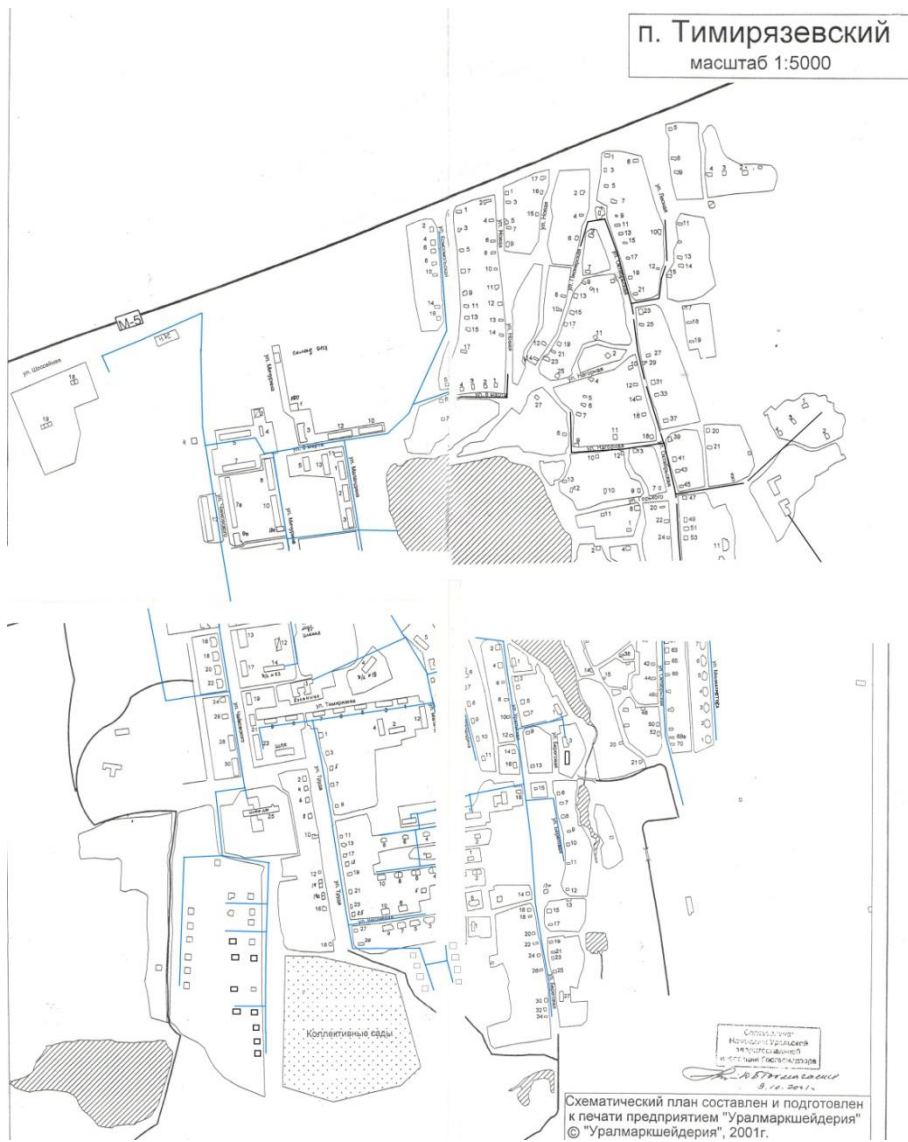
Рисунок 1. Схема централизованной системы холодного водоснабжения поселка Тимирязевский
